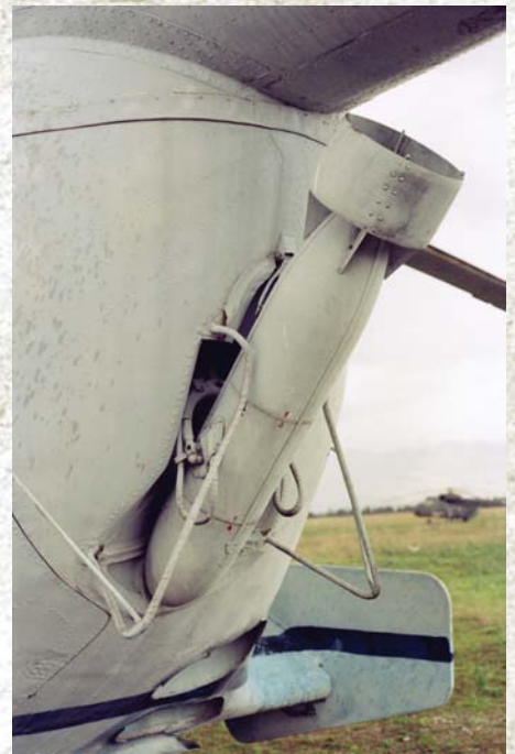
Гондола дејтекшора магнетних аномалија АПМ-60, која се у пошрази за подморницом теглила иза хеликоптера (Александар Рагић)
