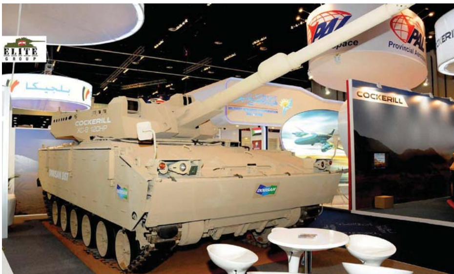
Јужнокорејско БВП К-21 са кућолом Cockerill XC-8 120HP
